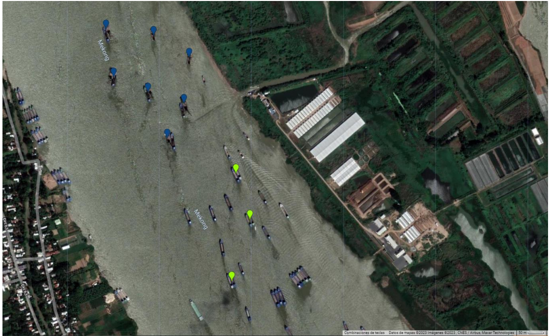
Hình 3-36: Sà lan có cần cầu hoạt động được phân loại thủ công so với tàu vận tải neo đôi (thể hiện các đặc điểm hình học giống nhau trong hình ảnh S2), khu vực ví dụ.
